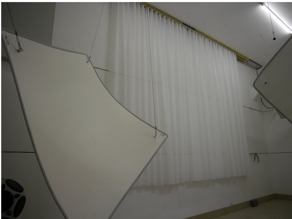
Abbildung B.2. Geraffte Prüfanordnung im Hallraum (diagonale Ansicht).
